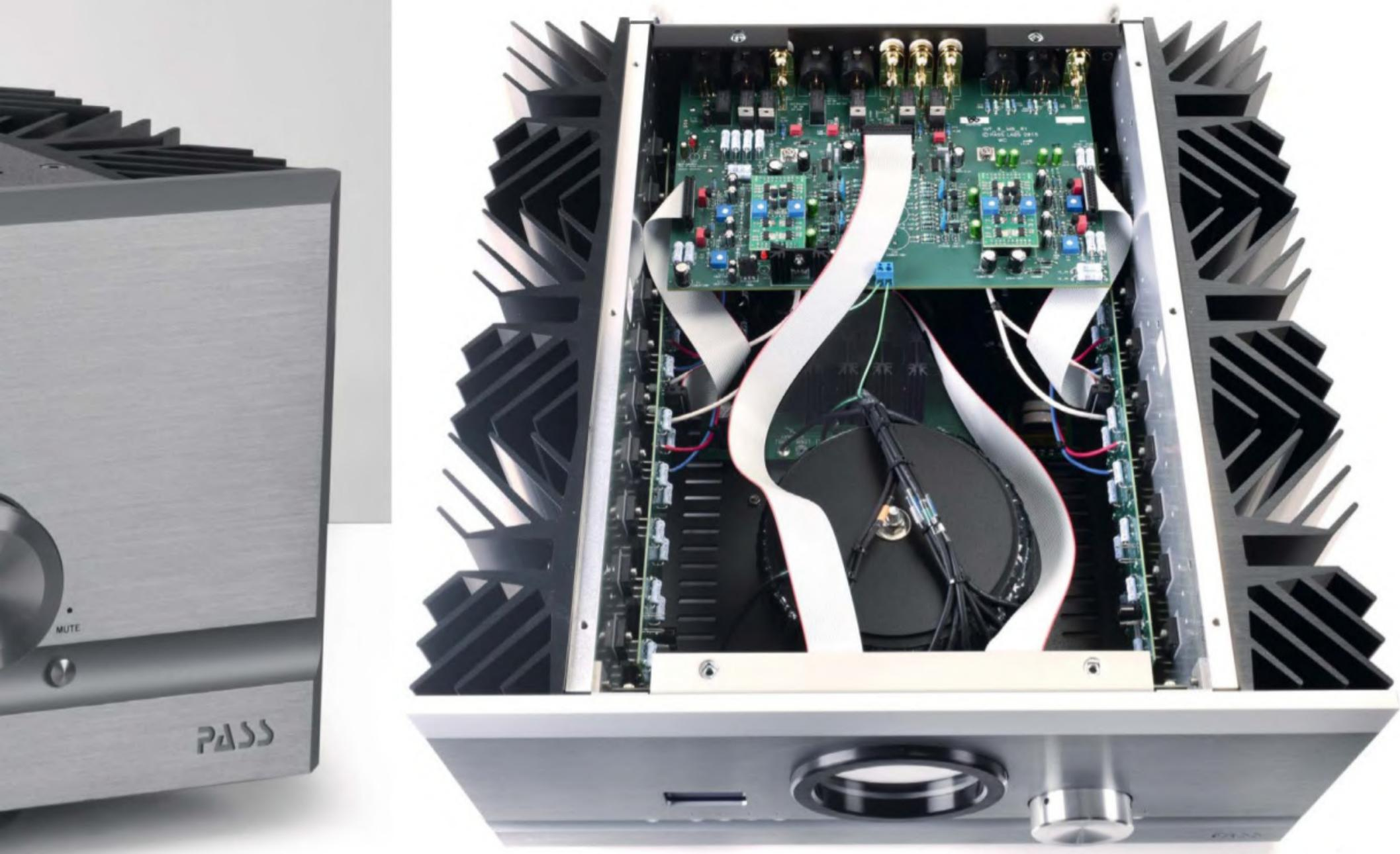
Seit Jahrzehnten die grundsätzliche amerikanische Art, einen leistungsfähigen Verstärker zu verpacken. Hinten hat die INT-250 zwei Griffe, was den Umgang mit dem schweren Amp deutlich erleichtert. Das „kurze“ Schaltungsdesign von Pass Labs mündet in überschaubaren Eingangs- und Treiberstufen.
